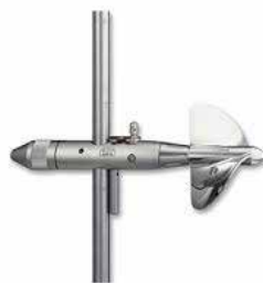
شکل ۷-۴۴. مولینه‌های مختلف (مولینه پروانه با محور افقی و مولینه فنجان‌ی با محور عمودی)
