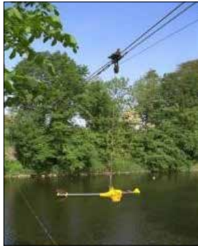
شکل ۷-۴۷. استفاده از پل تله فریک در رودخانه هایی که امکان ایستادن در داخل جریان نیست
