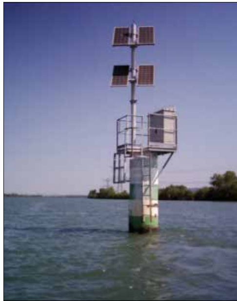
شکل ۷-۲۳. تصویری از پست‌های کنار رودخانه که روی آنها سنسورهای ترانزیت تایم نصب شده است.
