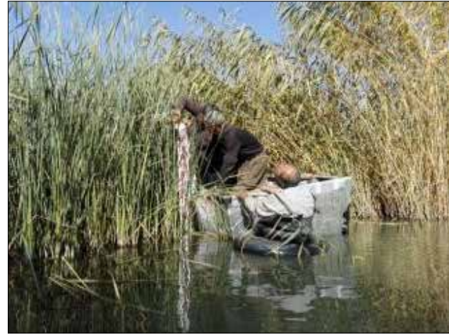
شکل ۹-۱۶. تصاویر نصب اشل فلزی ۲ متر در ورودی و خروجی تالاب نوروزلو
