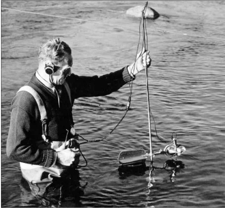
شکل ۷-۴۵. اندازه‌گیری با مولینه فنجانی در مقطع جریان رودخانه به همراه میله و دستی
