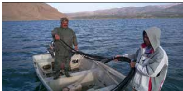
شکل ۹-۲۰. زنجیره سنسورهای نصب شده DO, EC و دما در سه عمق مختلف تالاب چغاخور ۹-۵ - نحوه بازنگری برنامه پایش و اصلاح شبکه پایش
