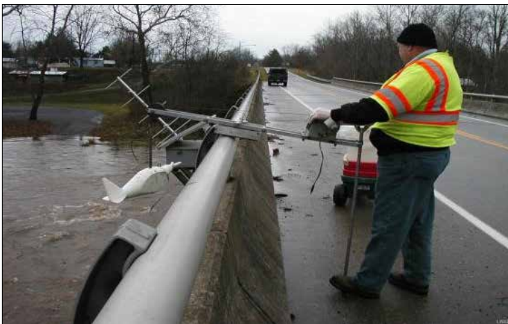
شکل ۷-۴۶. در مقطعی که پل روی رودخانه باشد می‌توان از آن پل‌ها برای مولینه زدن استفاده کرد
