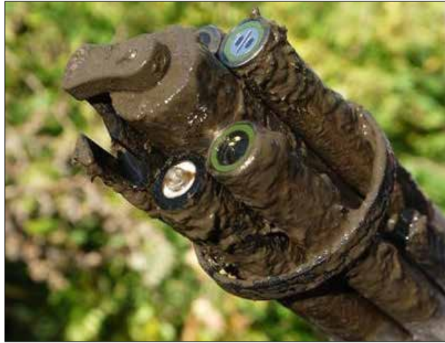
شکل ۷-۱۸. نمایی از سنسورهای اپتیکال بعد از تمیز شدن چشمی سنسورها
