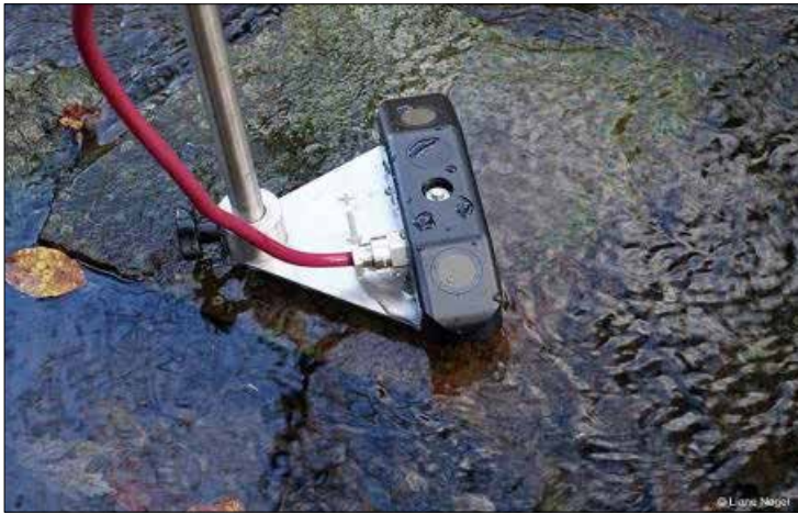
شکل ۷-۵۲. نمایی از سنسور آکواپروفایلر Mpro
