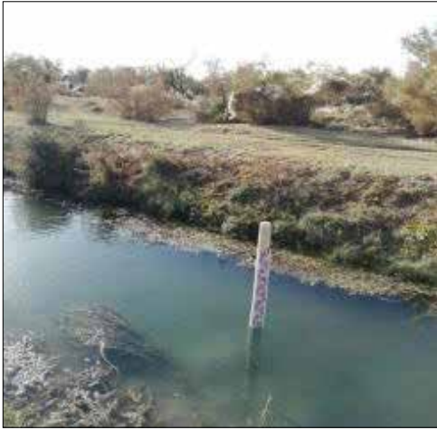
شکل ۹-۱۶. تصاویر نصب اشل فلزی ۲ متر در ورودی و خروجی تالاب نوروزلو
