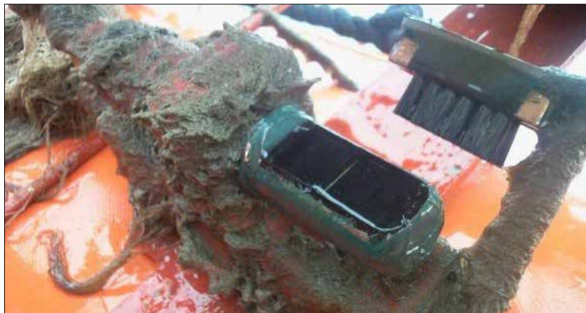
شکل ۷-۲۴. سنسور کدورت به همراه سیستم شستشوی مکانیکی
